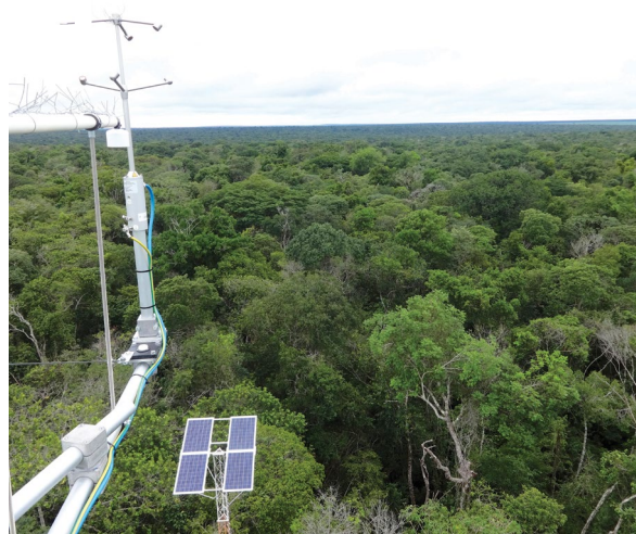
Tower to monitor the flux of CO 2 in the municipality of Quêrência, Mato Grosso.
